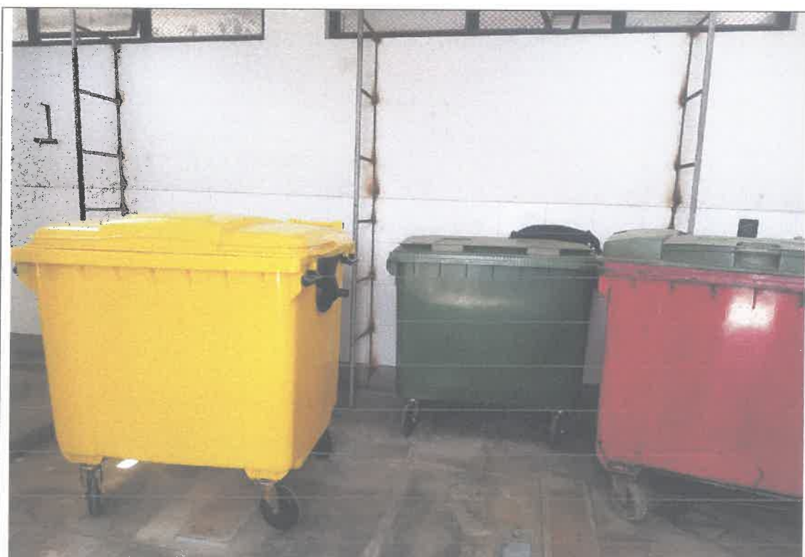
FOTOGRAFIA N° 4. Contenedores transportadores (coche), que sirve para trasladar los residuos sólidos (especiales, comunes y biocontaminados) desde los almacenamientos primarios hasta el almacenamiento central o final.
